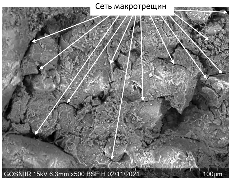
Рисунок 5.31 – Церковь Николы Мокрого в Ярославле. Образец кирпича западной стены с глубины 10 см. Увеличение 500х.
