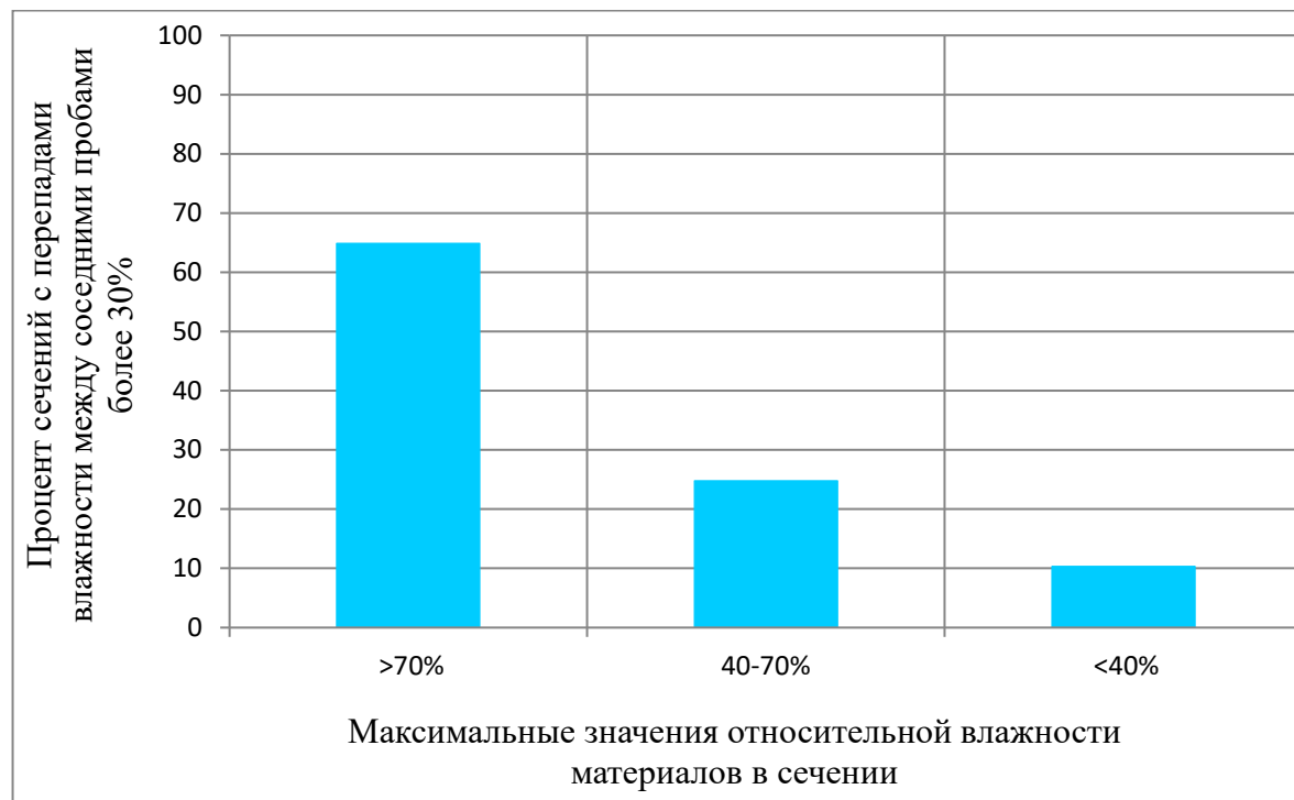
Рисунок 5.5 – Соотношение степени увлажнения материалов сечения с интенсивностью перепадов влажности соседних проб
