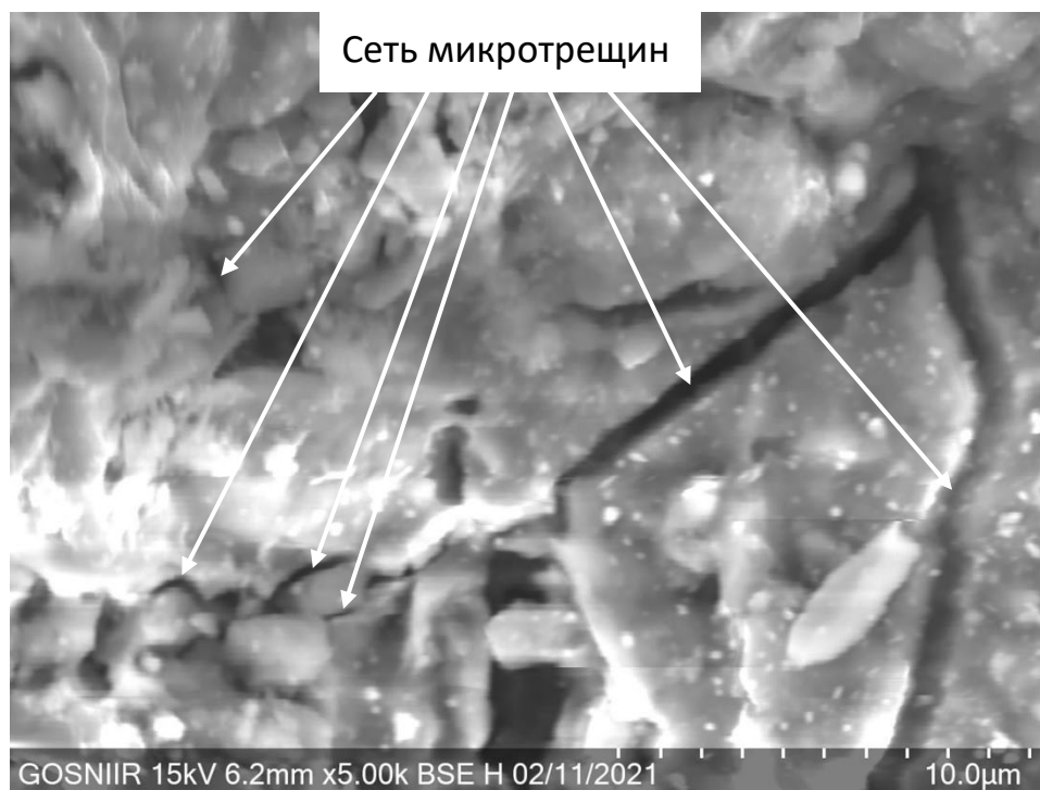
Рисунок 5.32 – Церковь Николы Мокрого в Ярославле. Тот же образец кирпича с увеличением 5000х.
