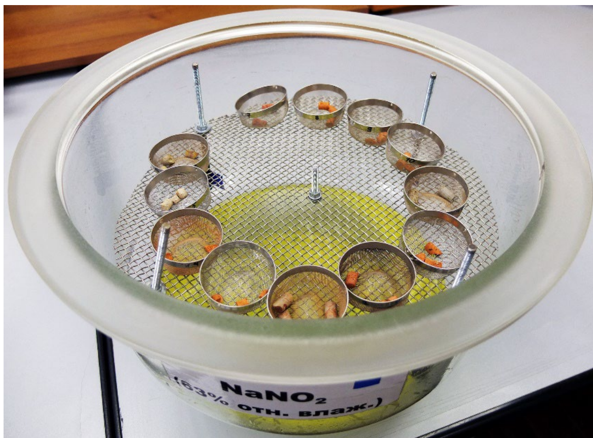
Рисунок 2.4 – Расположение корзинок с образцами в эксикаторе
