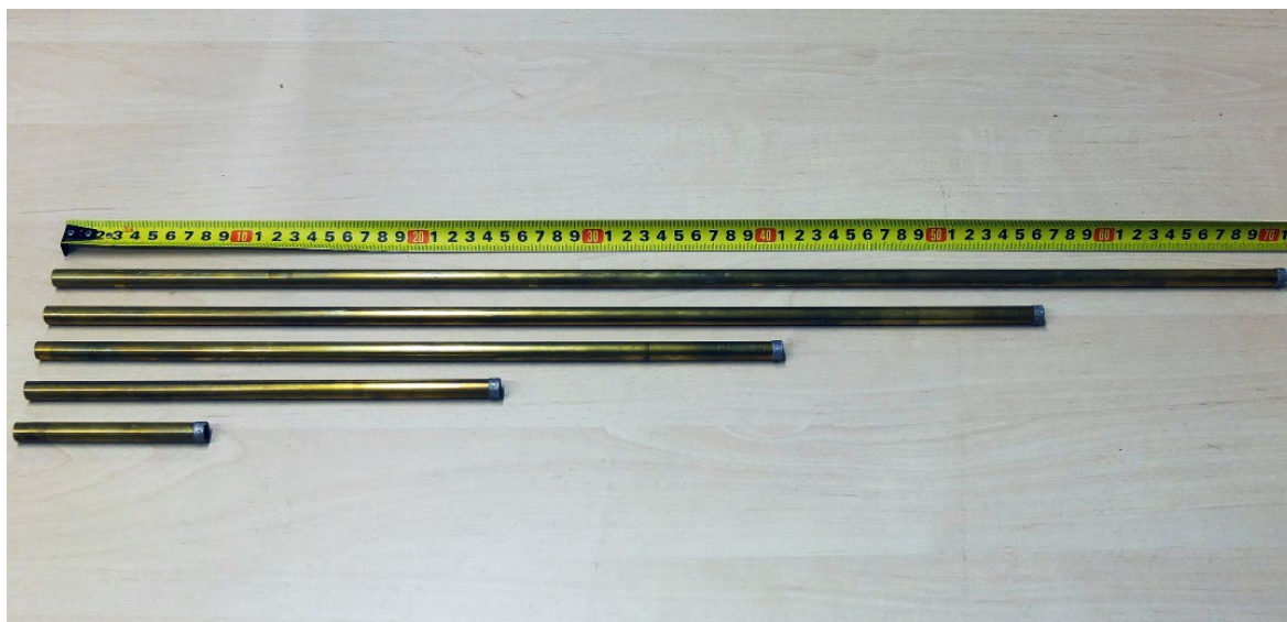
Рисунок 2.2 – Пробоотборники длиной от 10 до 70 см
